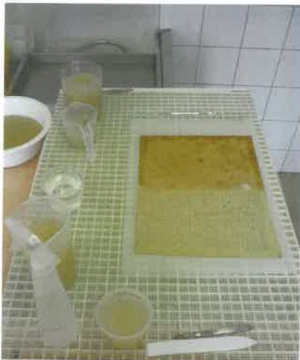
Kézi papíröntéses kiegészítés.
