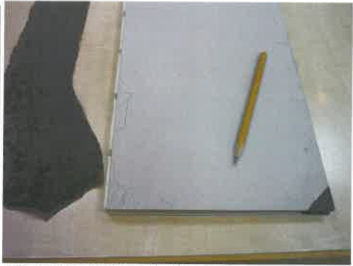
Hiánypótlás jelölése a betáblázott könyvtesten.
